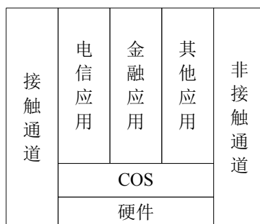
图 22 双界面(U)SIM卡逻辑结构图
