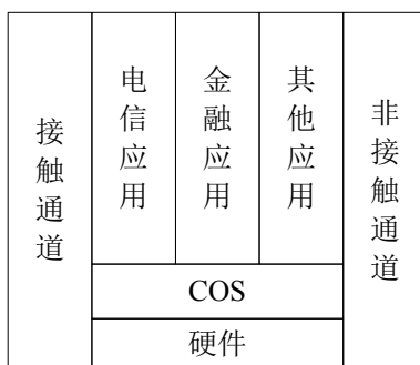
图 1 (U)SIM 卡逻辑结构图
