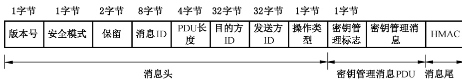
图 6 密钥管理指令在设备管理安全通道消息中的位置和格式
