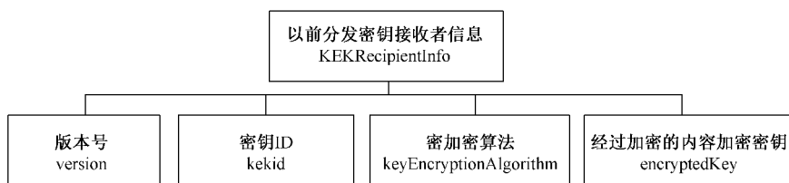
图 6 KEKRecipientInfo 类型结构框图
