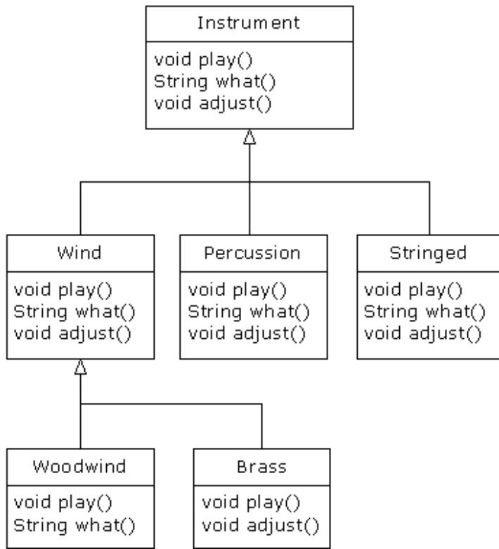
所有这些新类都能与老类——tune()默契地工作，毋需对tune()作任何调整。即使tune()位于一个独立的文件里，而将新方法添加到Instrument的接口，tune()也能正确地工作，不需要重新编译。下面这个程序是对上述示意图的具体实现：
