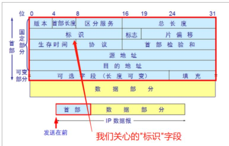
标识：唯一的标识主机发送的每一分数据报。通常每发送一个报文，它的值 + 1。当 IP 报文长度超过传输网络的 MTU（最大传输单元）时必须分片，这个标识字段的值被复制到所有数据分片的标识字段中，使得这些分片在达到最终目的地时可以依照标识字段的内容重新组成原先的数据。
