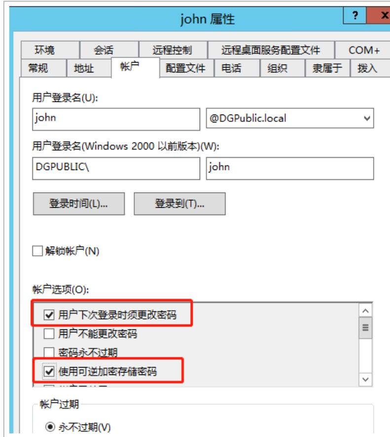
如图中的形式设置可以让他下次登陆时必须设置一个新密码，并且在域控中使用可逆加密存储新密码，这样当他修
