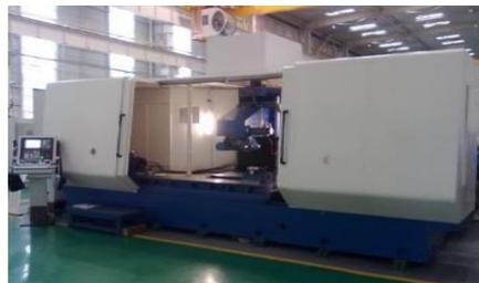
秦川机床QMK008精密拉刀磨
