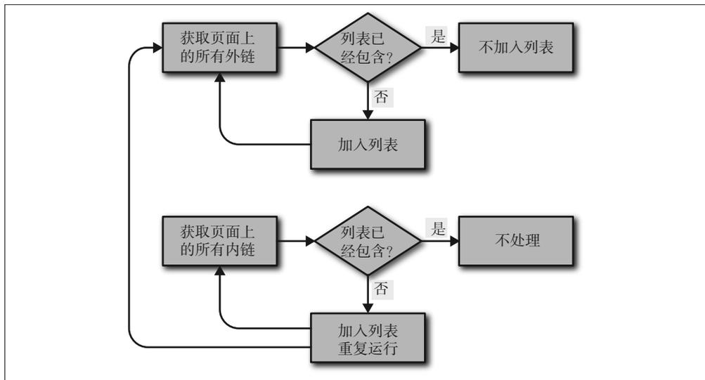
图 3-2: 收集内链和外链的程序流程图
